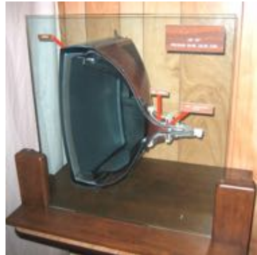
Αριστερά, σχεδιάγραμμα λειτουργίας οθόνης τηλεόρασης με καθοδικό σωλήνα. Δεξιά με την τομή διακρίνεται το εσωτερικό τμήμα μιας τηλεόρασης.
